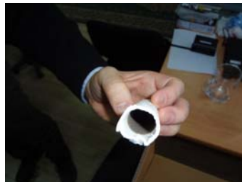
Цилиндр хэлбэрийн фильрт шүүж авсан тоосны дэг, фильртэй дотор талд тоос шүүгдэж саарал өнгөтэй болсон байна.
